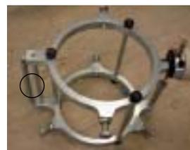
Le comparateur mesure le déplacement de l'anneau supérieur, **ce déplacement est égal à 2 fois le raccourcissement du tronçon d'éprouvette.**
