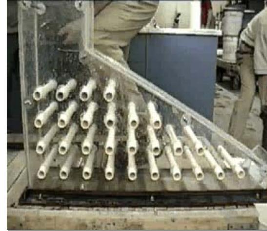
Béton de ciment alumineux autoplacant
